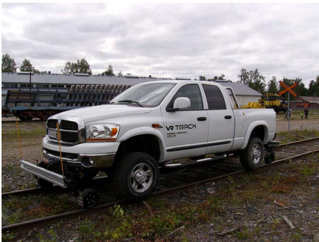
Foto 12 - Pick-up 4x4 strada rotaia in dotazione a VR track ( gestore dell' infrastruttura )
