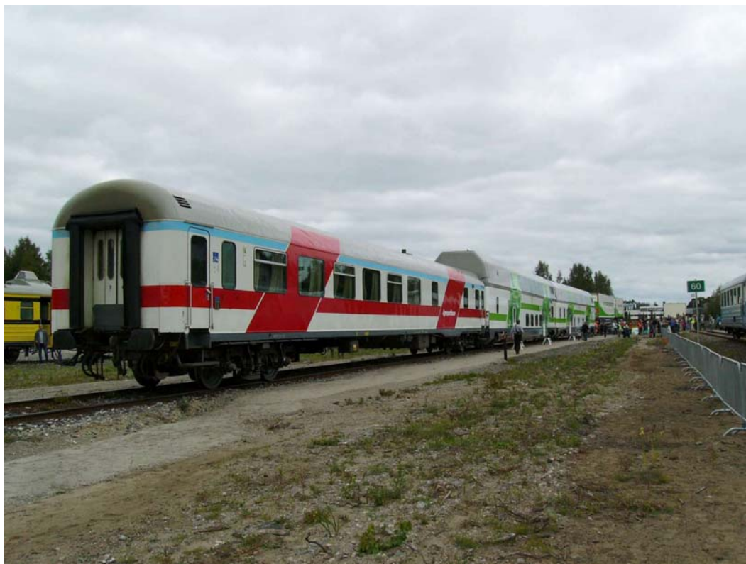
Foto 6 - Vetture moderne: in primo piano una carrozza mista con generatore per alimentare la condotta REC, in secondo piano due vetture Intercity bipano
