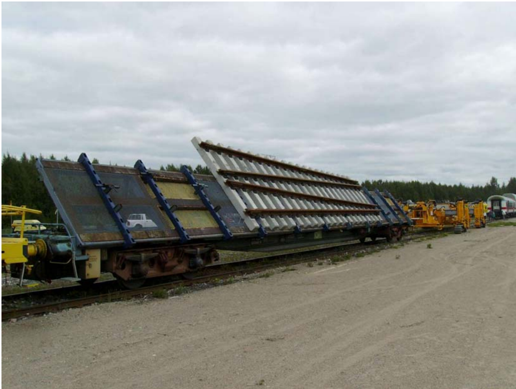
Foto 16 - Carro per trasporto di scambi completi preassemblati in officina
